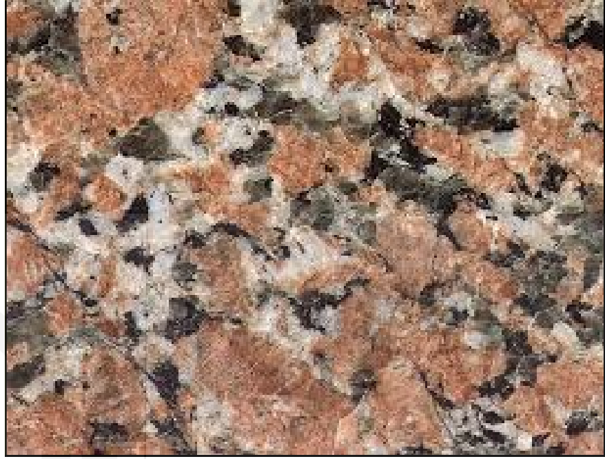
चित्र 1.6 : समकणिक गठन दिखाता ग्रेनाइट का हस्त नमूना।
